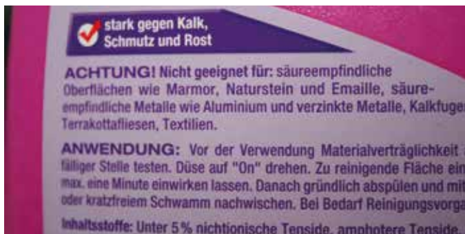
Fig. 12 – Producenter henviser kun indirekte til risikoen. Derfor skal lægmanden informeres af fagmanden.
